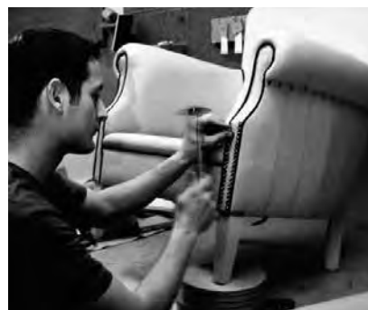
Letzte Befestigungsarbeiten an den Frontseiten
