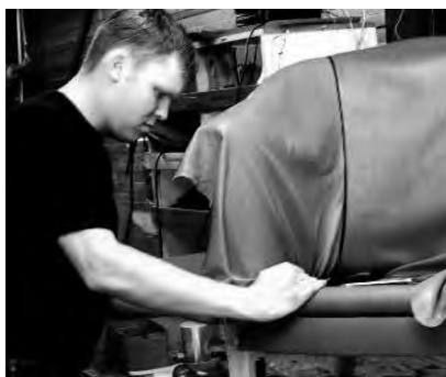
Der Polsterer bekleidet das Gestell mit feuchten Schafleder
